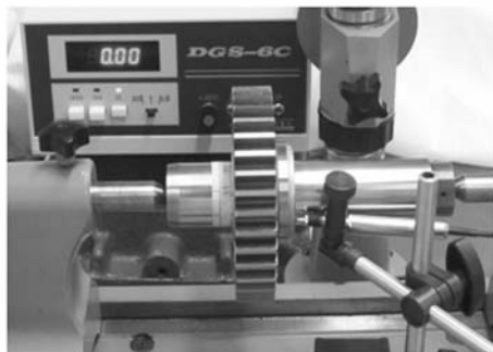
(b) 齿坯定位面的测量
