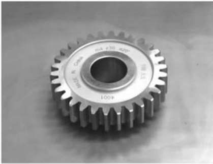
(d) 齿坯定位面的修研
